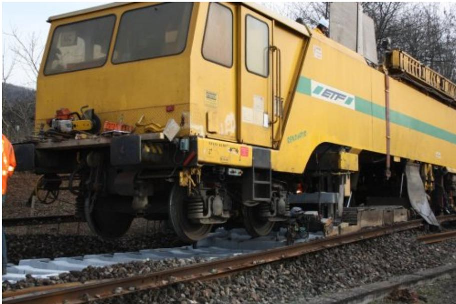
L'arrière de la machine reposant sur la chenille
