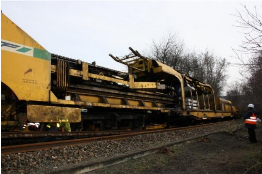
**Chargement automatique de la machine avec les nouvelles traverses**
