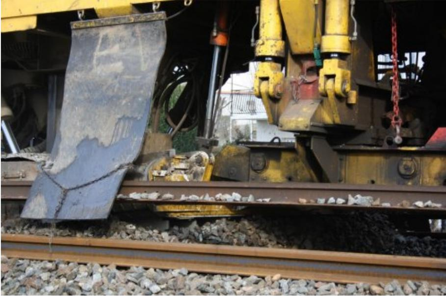
L arrière de la machine est tenu par 4 vérins avec une chenille
